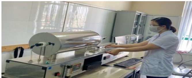
Hình 1: Thiết bị ESO-1 xác định chỉ số tự cháy Sz^a và năng lượng hoạt hóa E.
