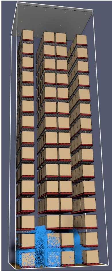
a) Mô hình bố trí hàng hóa, đầu phun.
