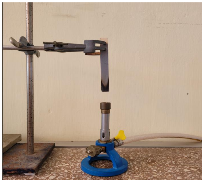
Hình 2: Bố trí thí nghiệm theo tiêu chuẩn UL94-V.
