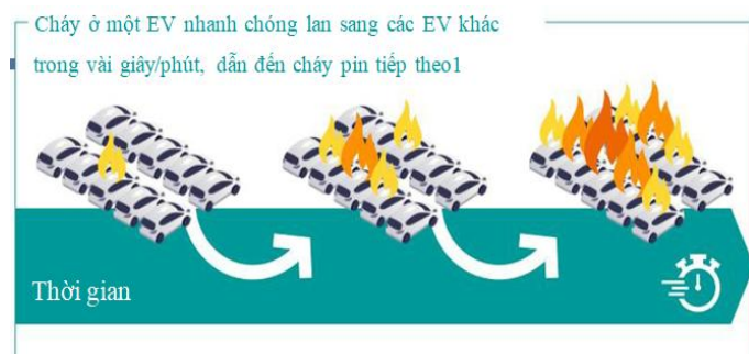
Hình 2: Đặc điểm cháy lan của garage có xe điện.
