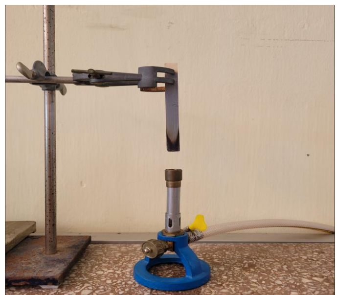
Hình 2: Bố trí thí nghiệm theo tiêu chuẩn UL94-V.
