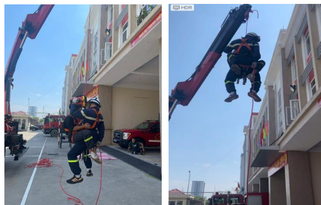
Hình 3: Sử dụng ròng rọc điện kết hợp với cầu trên xe CNCH để cứu người bị nạn từ trên cao xuống.
